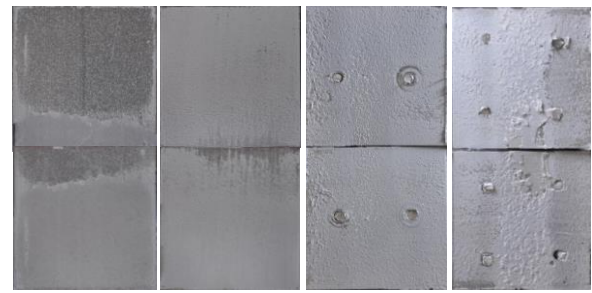
写真1 接着破壊面 (エポキシ)
