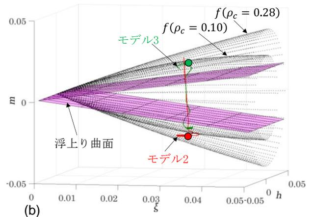
図7 地盤の荷重状態 (EI Centro NS、 $H/L = 3$ ) : (a)  $T_1 = 0.3$  s ( $t = 3.0 \sim 4.0$  s)、(b)  $T_1 = 1.0$  s ( $t = 6.0 \sim 7.0$  s)
