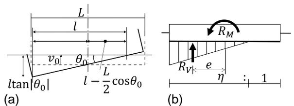
図3 浮き上がり時の基礎の挙動: (a)基礎と地盤の幾何学的関係、(b)地盤の鉛直反力分布
