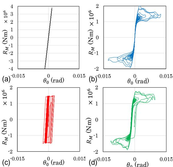
図4 基礎回転の復元力特性 (El Centro NS、 $T_1=0.3$  s、 $H/L=3$ ) : (a) モデル0、(b) モデル1、(c) モデル2、(d) モデル3
