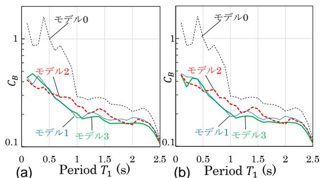
図5 ベースシア係数スペクトル (El Centro、 $H/L=3$ ) : (a) 水平動のみ、(b) 水平動+鉛直動
